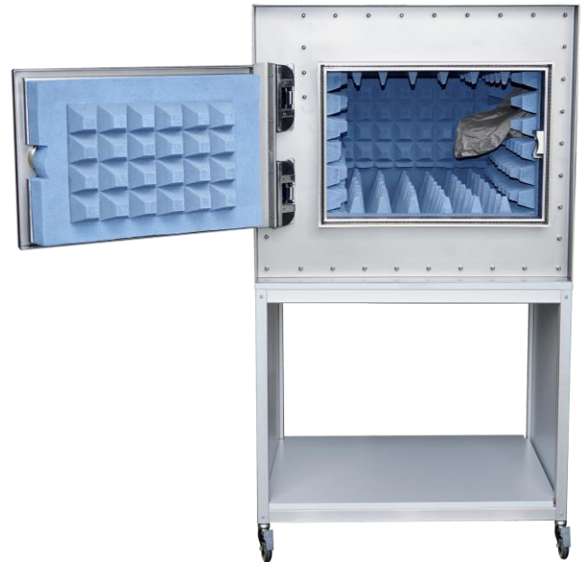
Abb. 2: Messkammer mit den Abmessungen 780 x 800 x 680 mm und fahrbarem Untergestell
